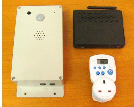
而透過加裝電子定時開關裝置，可為器材設定特定的開動時間，以減少不必要之干擾及節約用電。本器材前面設有插咭位置，方便照顧者插上合適的提示圖咭配合錄音內容。網絡版自動錄音提示器套裝包括無線提示器，網絡路由器及可編程電插座一個。
