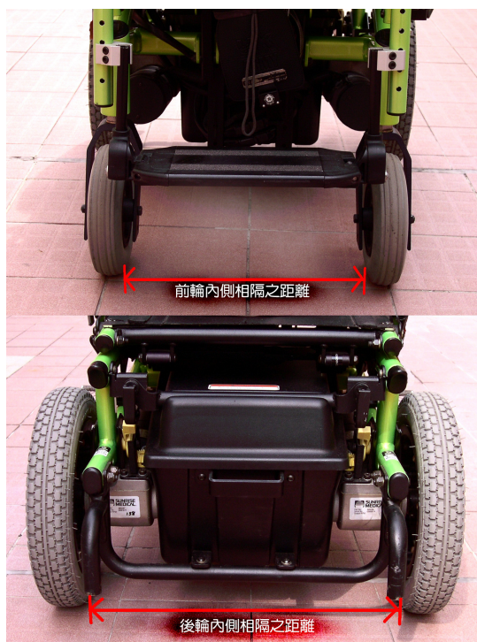
圖四：提供前後輪內側相隔之距離，用作設計斜台之闊度和之間距離的參考。
