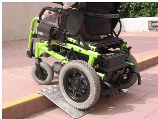
圖三：一位使用者正使用一對「便攜式鋁斜台」，於斜台的正面上落。
